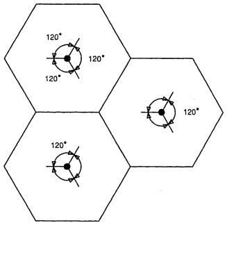
CELL SITE USING DIRECTIONAL ANTENNA
