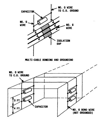
CAPACITOR INSTALLATION (CABLES NOT SHOWN)
