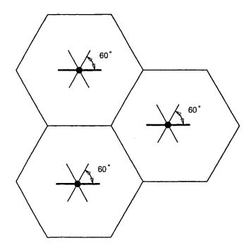
CELL SITE USING DIRECTIONAL ANTENNA
